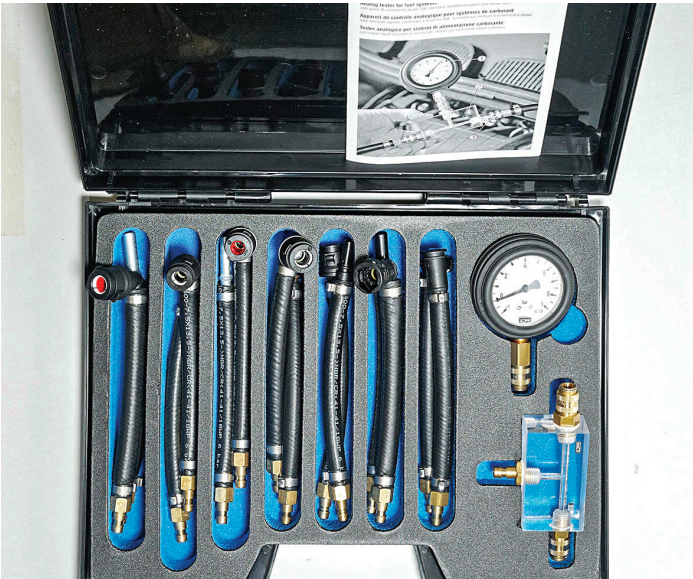
Bild 3 Die Auswahl an Adaptern zum Anschluss an die SAE-Verbinders des Kraftstofffilters. Die Anschlüsse sind mit jeweils gleichen Nummern paarig vorhanden
