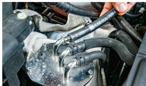
Bild 8 Adapter in Zuleitung einstecken und mit vorhandener Federbandschelle sichern
