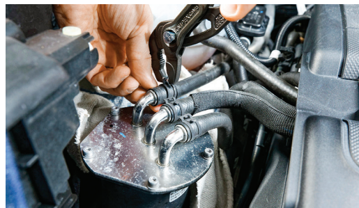
Bild 7 Zuleitungsschlauch zum Filter mit Knipex Federbandschellenzange 85 51 250 A lösen und Klemme auf Schlauch nach hinten schieben
