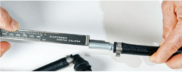
Bild 2 Die vorgefertigten Adapter zum Einschleifen des Geräts unterscheiden sich oft nur minimal. Für präzise Zuordnung des Anschlusses empfehlen wir den Einsatz eines Messschiebers
