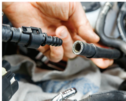
Bild 9 Zweiten Anschluss des Messgeräts in die Zuleitung von der Vorförderpumpe einsetzen und idealerweise mit breiter Bandschelle (meist Sechskant SW 7) sichern
