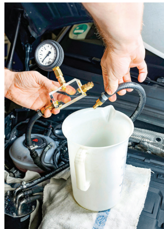
Bild 13 Nach beendeter Messung System rückbauen, Verbindungen an möglichst hoher Stelle trennen, mögliche Dieselreste mit Lappen aufnehmen und fachgerecht entsorgen
