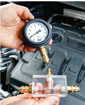
Bild 3 Die Auswahl an Adaptern zum Anschluss an die SAE-Verbinders des Kraftstofffilters. Die Anschlüsse sind mit jeweils gleichen Nummern paarig vorhanden
