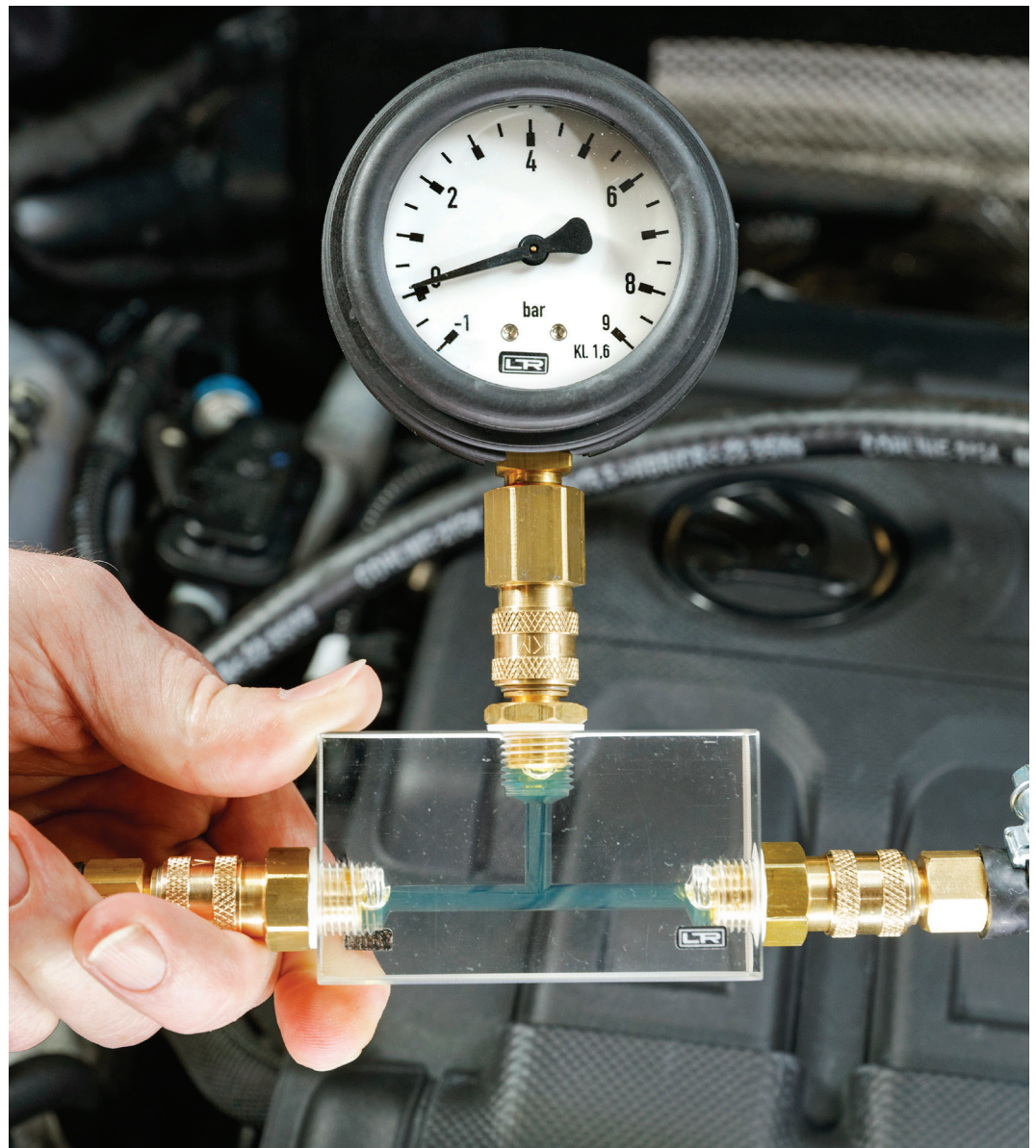
Bild 1a und b Das analoge Prüfgerät für Kraftstoffsysteme LR 180 AK2 der Fa. Leitenberger eignet sich zum Prüfen des Kraftstoffvordrucks
